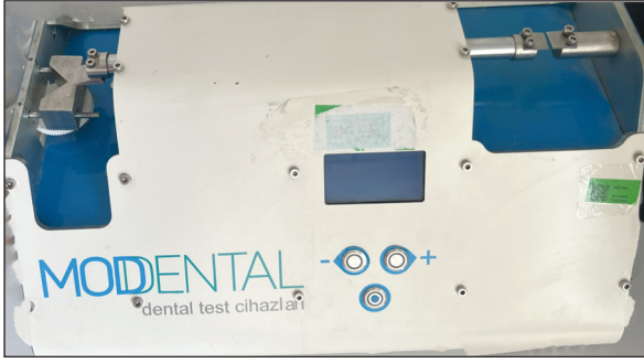
RESİM 3: Mikro makaslama test cihazı (MOD Dental MIC-101, Esetron Smart Robototechnologies, Ankara, Türkiye).
